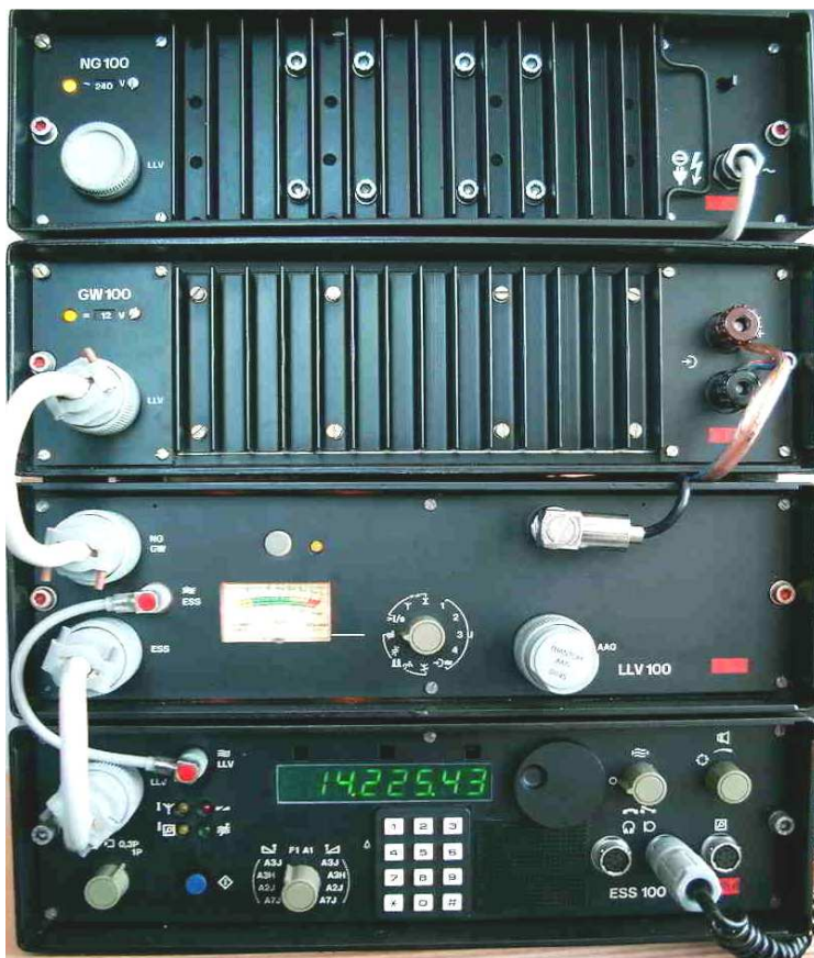
Bild 1: komplette Funkanlage SEG-100D – umgebaut wie im Beitrag beschrieben;
