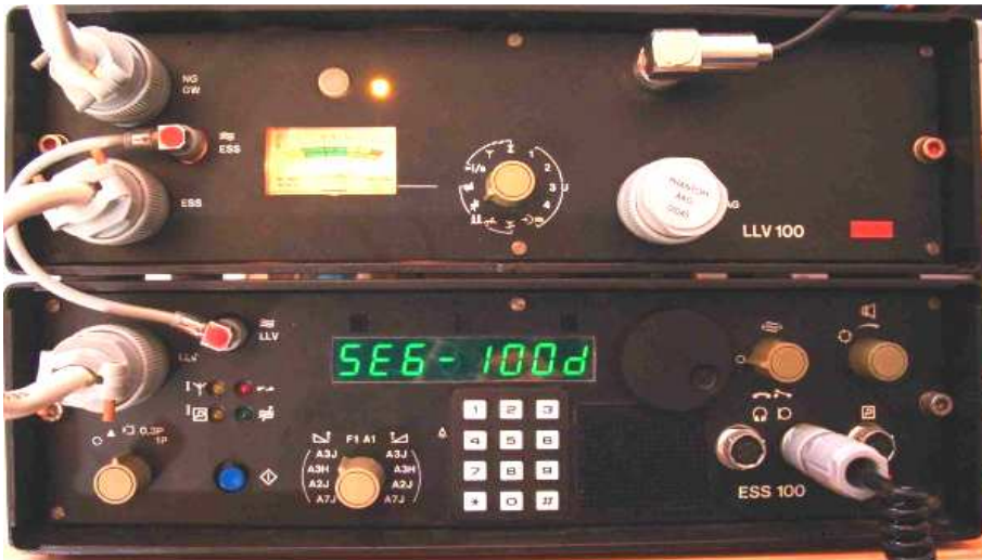
Bild 10 Detailansichten der umgestalteten Frontplatten, neben der Tastatur befindet sich die Öffnung für den internen Lautsprecher, Zustand des ESS100 nach dem Einschalten mit Anzeige von Softwareversion und Gerätetyp
