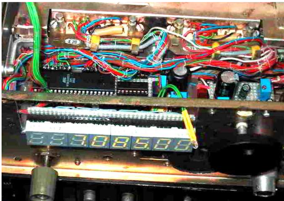
Bild 9: Verlegung der Kabelbäume; ein Abbinden der Kabelbäume mit Zwirn ist zu empfehlen, rechts oben am Display der Fototransistor der Helligkeitsregelung, neben dem Display der Drehgeber, hinter dem Drehgeber der NF-Verstärker
