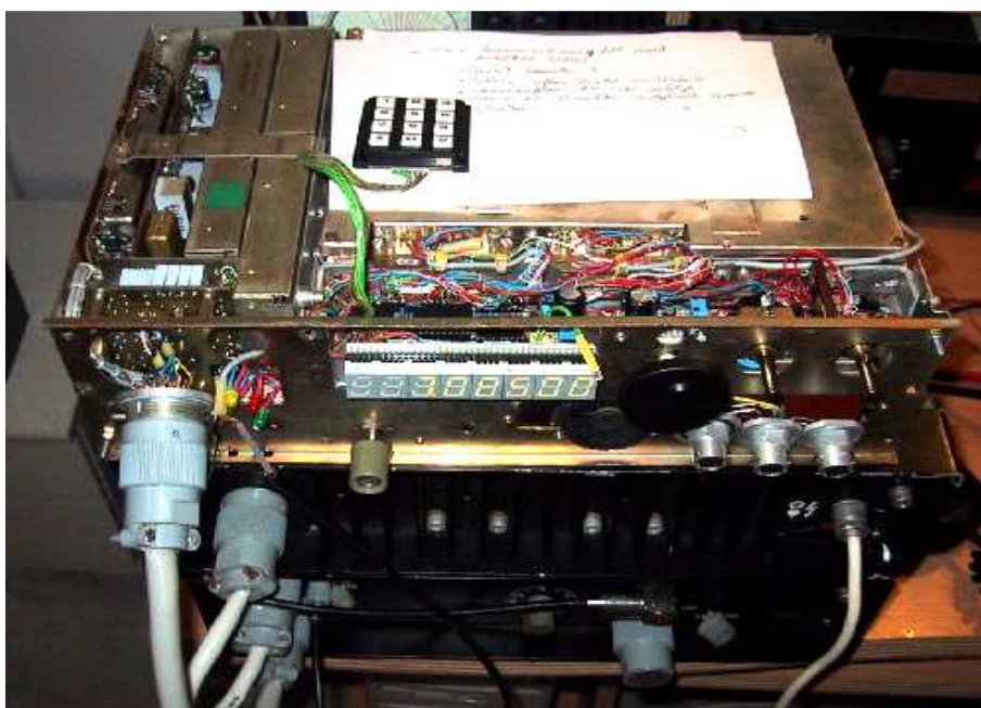
Bild 5: Einbau der neuen Baugruppen im ESS100; in der Mitte die Anzeigeeinheit an der Stelle der drei rechten Frequenzwahlschalter, rechts daneben der Drehgeber an Stelle des 1kHz Frequenzwahlschalters, hinter dem Drehgeber der NF-Verstärker, unter dem Drehgeber der Lautsprecher
