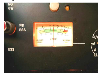
Bild 7: Detailansicht des eingebauten des S-Meter, die LED wurde nach oben neben den Abstimmknopf verschoben
