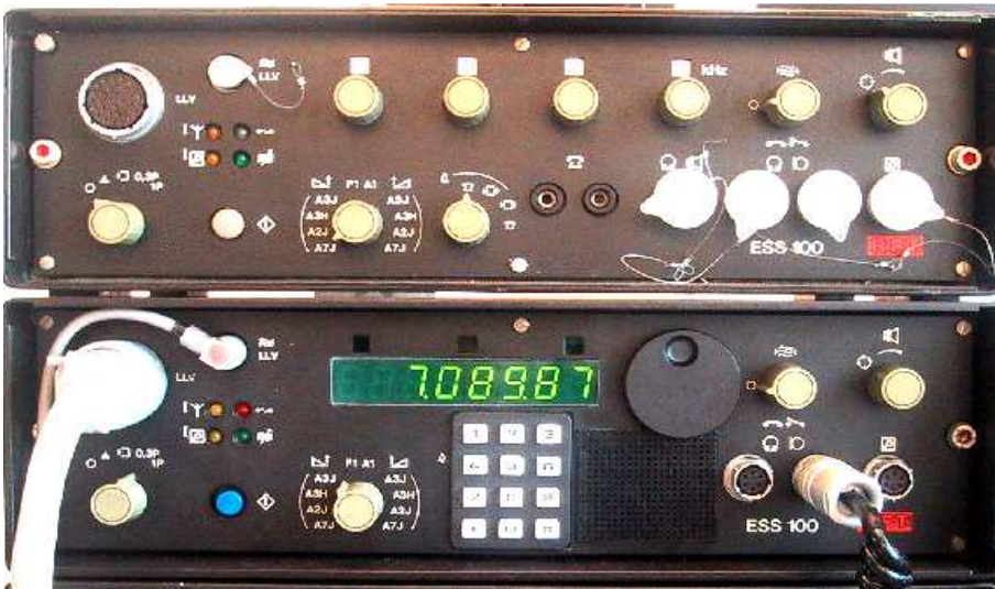
Bild 8: SEG-100D: Systemkomponente ESS 100; oben jungfräuliches ESS 100 mit Frequenzwahlschaltern und ausschließlich externen Lautsprecher; unten umgebautes ESS100 mit komfortabler Frequenzeinstellung und -Anzeige sowie internen Lautsprecher; aus Platzgründen wurde das S-Meter im LLV 100 eingebaut
